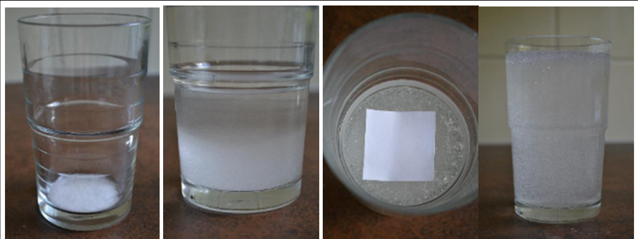
Abbildung 3: Wasseraufnahme durch den Superabsorber
